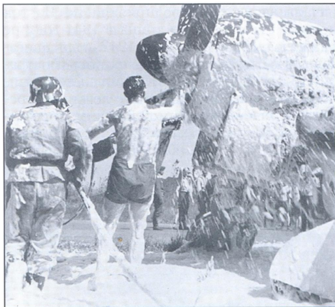
Первые Fw 190 отличались низкой надежностью – механики и пожарные тушат загоревшийся двигатель
