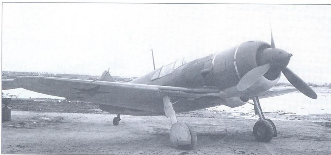
Первый ЛаГГ-3, переделанный под мотор воздушного охлаждения М-82
